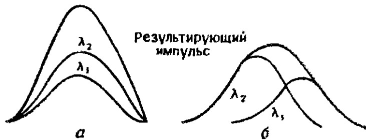
Рис. 17.20. Уширение импульса вследствие материальной дисперсии: а — исходный импульс, б — выходной импульс.
