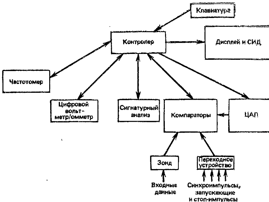
Рис. 16.6. Блок-схема сигнатурного анализатора, включающего в себя цифровой вольтметр и частотомер.
