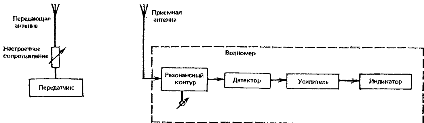
Рис. 15.9. Измерение резонансной частоты антенны с помощью волномера.
