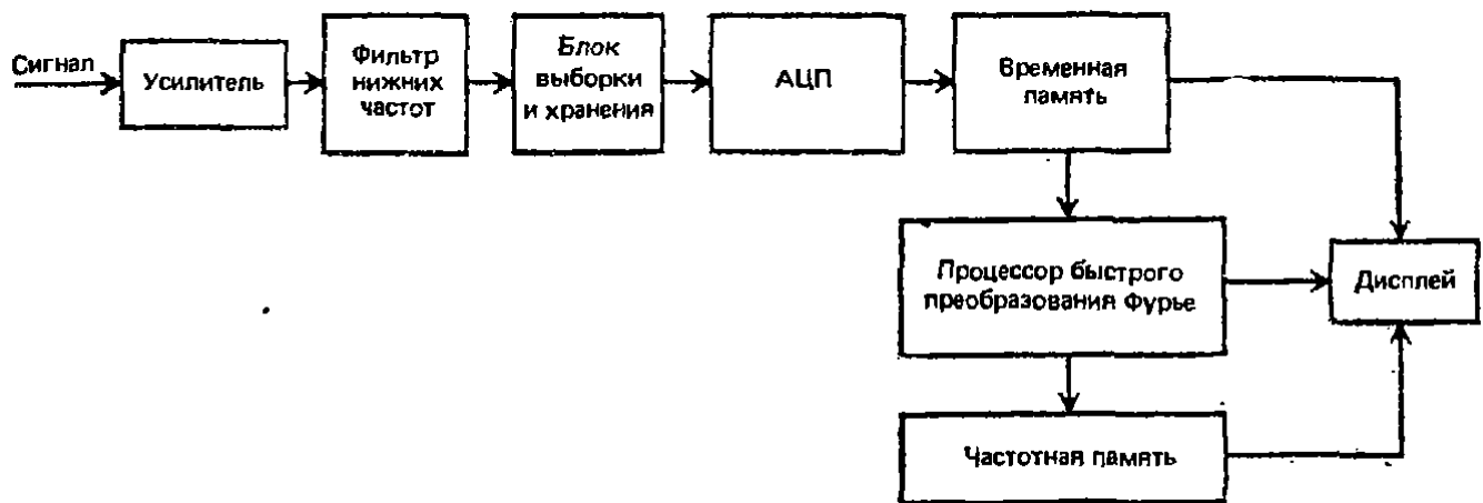
Рис. 11.4. Блок-схема анализатора спектра с использованием быстрого преобразования Фурье.
