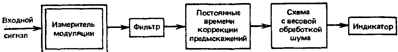
Рис. 15.25. Схема включения измерителя коэффициента модуляции для определения отношения сигнала к шуму.
