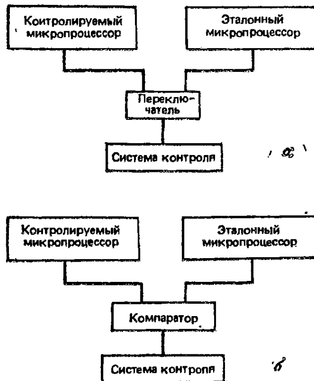
Рис. 13.58. Проверка микропроцессора методом сравнения: а — режим переключения, б — режим сравнения.
