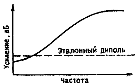
Рис. 15.7. Зависимость коэффициента усиления антенны от частоты по отношению к эталонному диполю.
