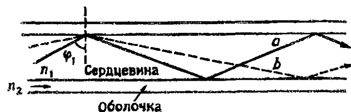
Рис. 17.12. Распространение света в волокне со ступенчатым изменением показателя преломления.
