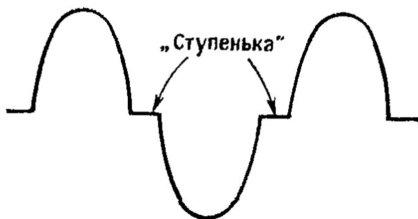
Рис. 14.13. Искажения типа «ступеньки».
