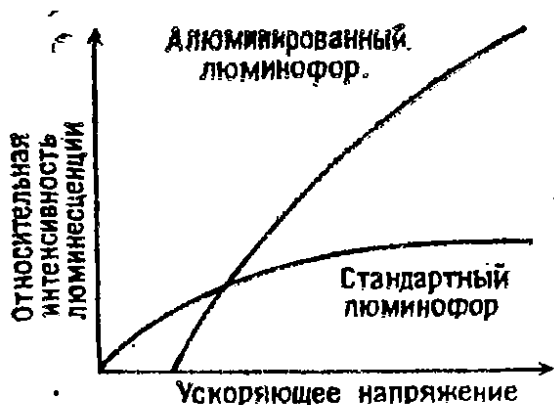
Рис. 12.9. Сравнение люминесценции стандартного и алюминированного люминофоров.
