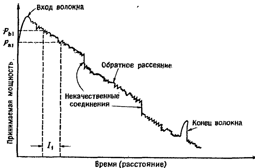
Рис. 17.23. Рассеянная мощность от возбуждающего импульса.
