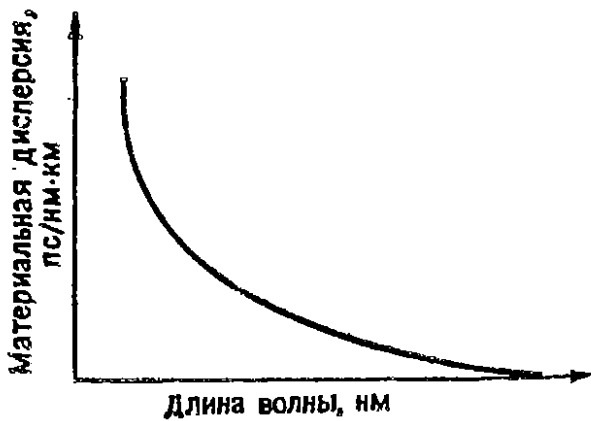
Рис. 17.21. Зависимость материальной дисперсии от длины волны в типичном волоконном световоде.
