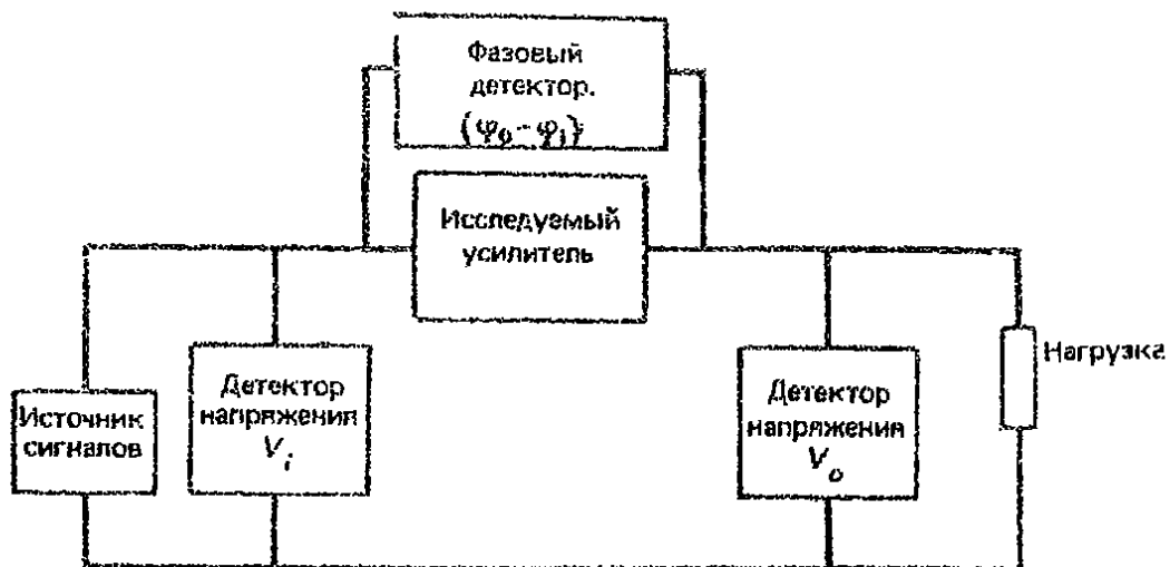
Рис. 14.9. Блок-схема измерения коэффициента усиления и фазового сдвига усилителя.
