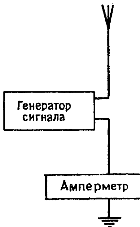
Рис. 15.8. Измерение резонансной частоты антенны с помощью последовательного амперметра.
