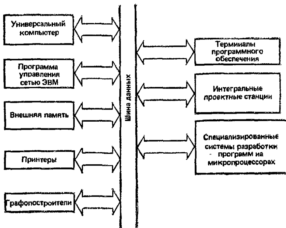
Рис. 16.40. Операционная среда при разработке проекта системы на основе микропроцессора.
