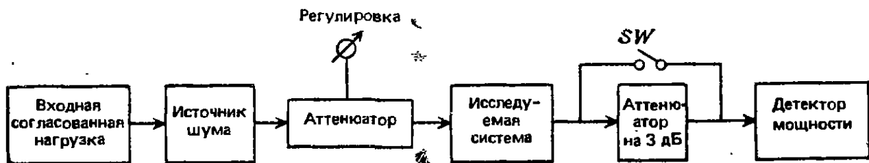
Рис. 11.8. Метод удвоения мощности для измерения коэффициента шума.
